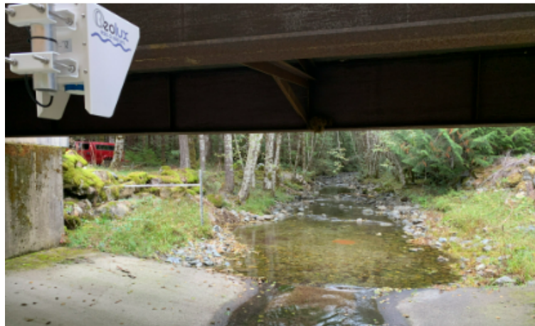
Imatge 19. Exemple d'orientació del radar en punt de secció coneguda
